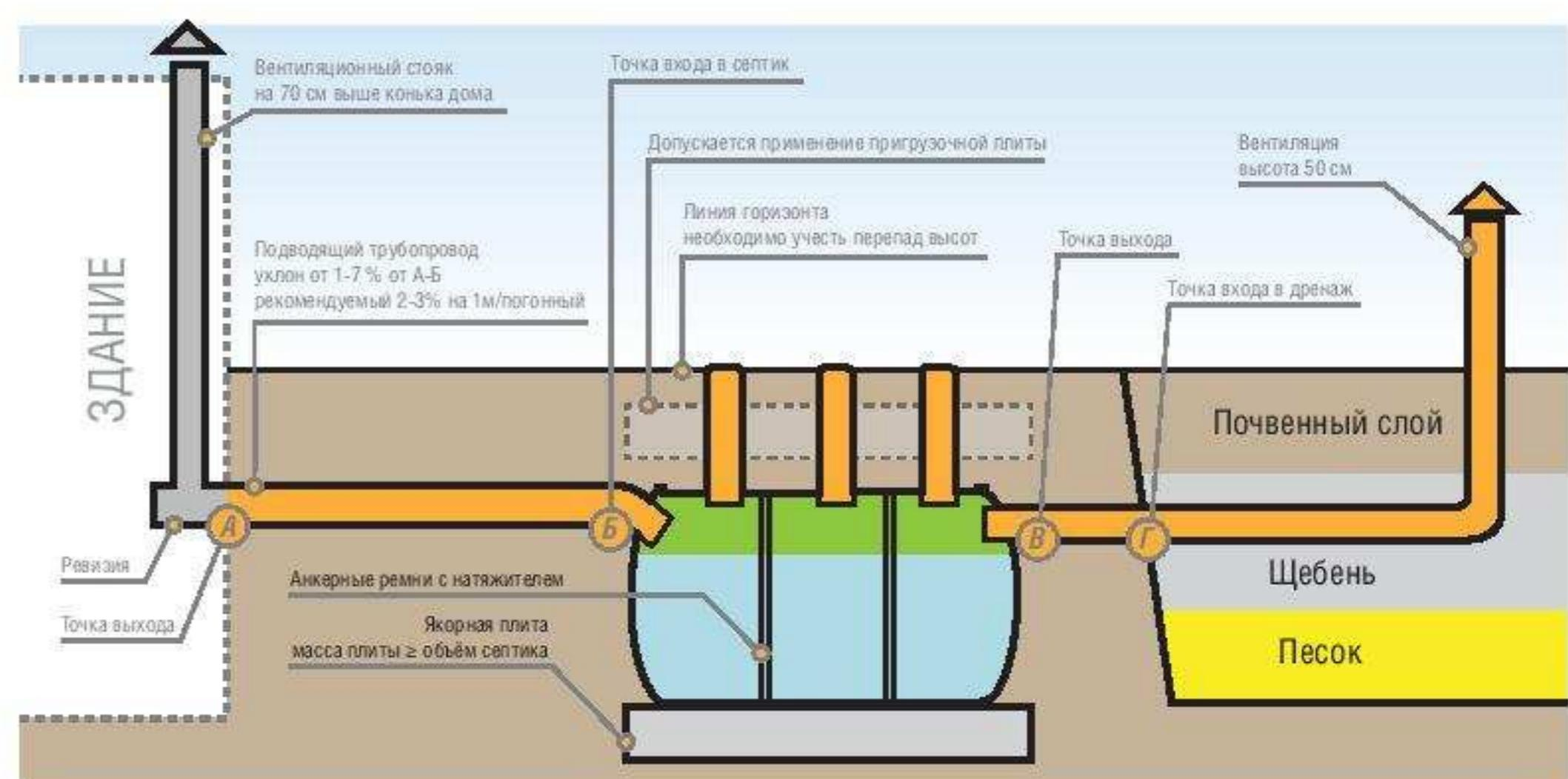
**Напорная схема водоотведения применяется
