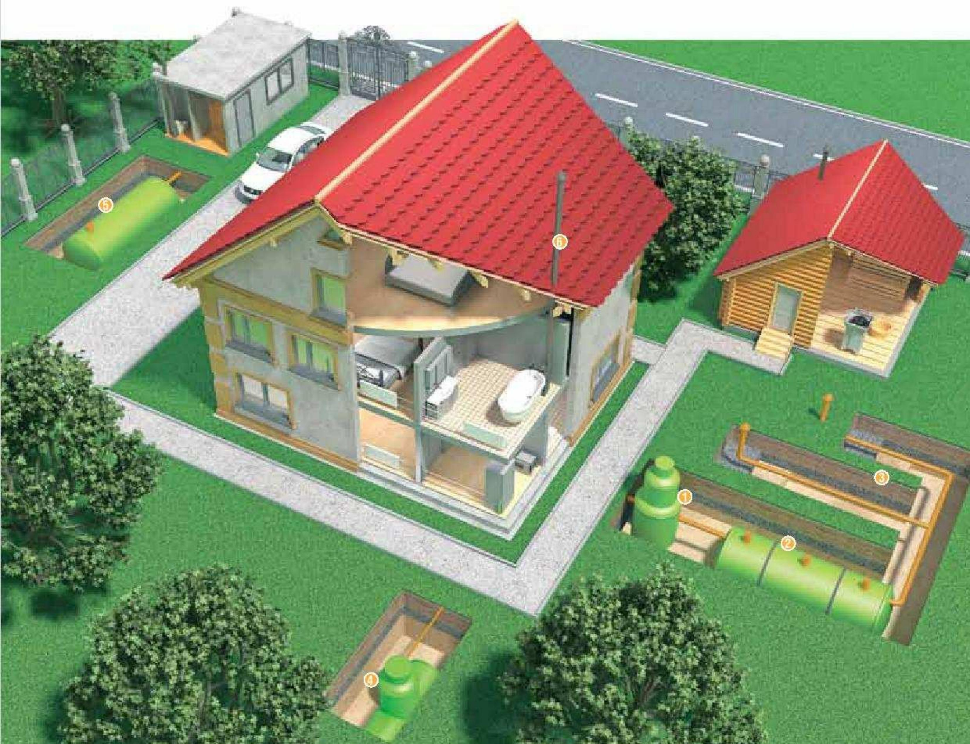
1 Распределительный колодец 2 Септик 3 Впитывающая площадка 4 Топливная ёмкость 5 Накопительная ёмкость 6 Вентиляция
